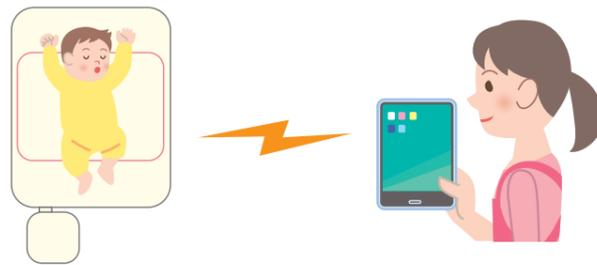
センサーマットから感知される心拍、呼吸、体動の生体情報をサーバーを通してモニターに表示します。
